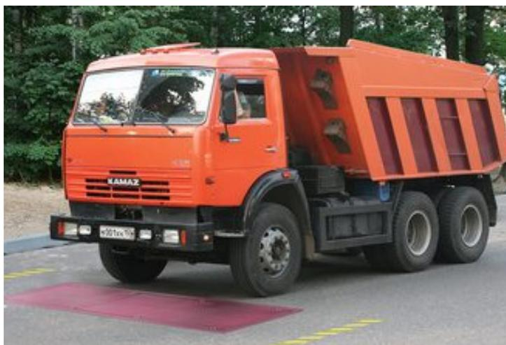
Универсальные весы для врезной установки, предназначенные для поосного взвешивания любых автомобилей и автопоездов в движении и в статике (поосно или потележечно), а также для определения веса поосного и каждого колеса в отдельности.
